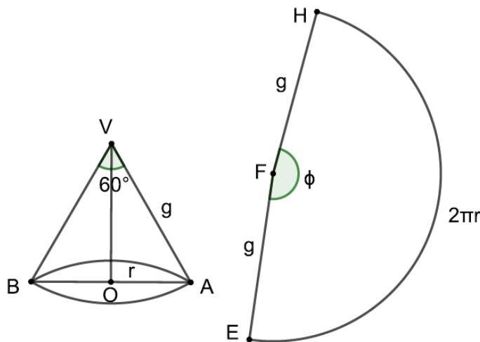
Hay que calcular el ángulo  $\phi$ . Tenemos que el área lateral del cono es  $\pi r g$ . Por otra parte podemos calcular el área lateral recurriendo a una regla de tres (entre las magnitudes área y ángulo)
