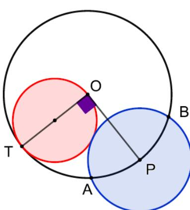
Sea una circunferencia de centro O y radio R. Se dibuja la circunferencia tangente interior a la primera con diámetro R. Se dibuja un radio OP perpendicular al OT. Con centro en P se dibuja una circunferencia tangente exterior a la segunda. Sean A y B los cortes de la primera y tercera circunferencias. Calcular el radio de la tercera circunferencia y demostrar que el lado del pentágono regular inscrito en la primera circunferencia es AB
