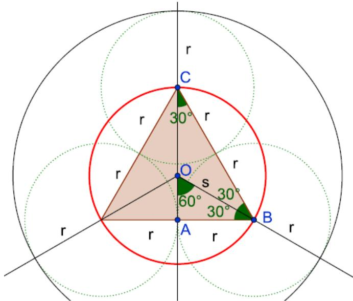
Tenemos que  $\Delta CAB \approx \Delta OAB$  ya que los dos son triángulos  $30^\circ-60^\circ-90^\circ$  y sus lados están en la proporción  $1:\sqrt{3}:2$  y de aquí:
